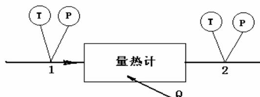
冷媒流经“1”点后经量热计再通过“2”点，由于从外部向量热计加入热量“Q”，所以冷媒的比焓从  $h_1$  增大为  $h_2$ 。 $h_1$  和  $h_2$  是根据测量该点冷媒的温度和压力计算得到的。由于计算的需要，在“1”点冷媒应当是过冷的，在“2”点冷媒应当是过热的。根据能量守恒原理，应有以下平衡式：
